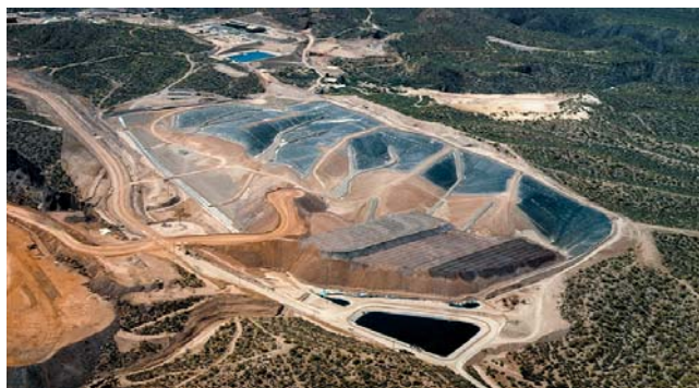
200万平方英尺 (18万平方米) 的GSE HD土工膜用于一座铜矿的堆浸场。
